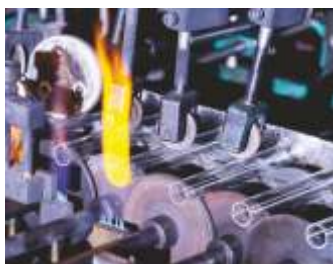
TEST TUBE MACHINE: 40000 PCS PER SHIFT
